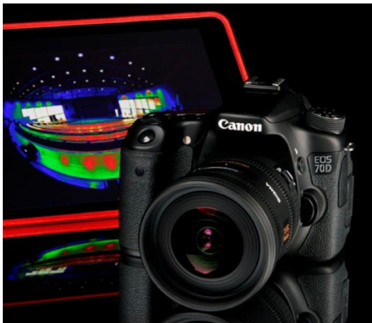
Abb. 16: Kalibrierte Digitalkamera für bildauflösende Leuchtdichteauswertungen des ganzen Umfeldes.
