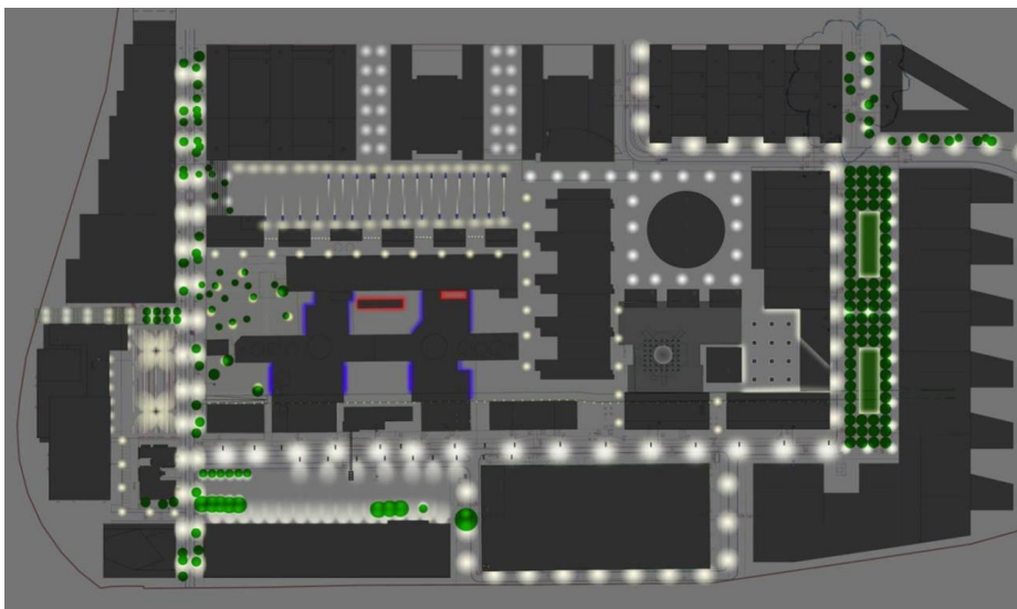
Abb. 13: Cité Esch-Belval Quest Gesamtplanung. Der Masterplan zeigt die Funktionalbeleuchtung im Zusammenhang mit der Akzentbeleuchtung und stellt Hierarchien der Beleuchtung innerhalb des Gebietes dar.
