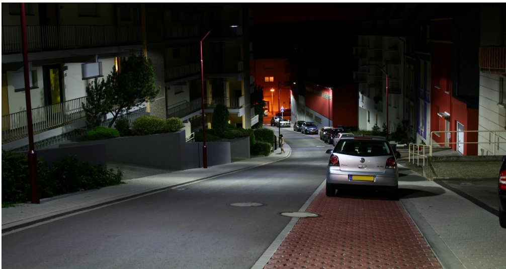
Abb. 30: Blendfreie Straßenbeleuchtung in kleinstädtischer Umgebung, Beispiel Schiffflange.
