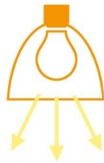
Abb. 76: Lichtstärke I in Candela (cd) als Maß für die räumliche Verteilung des Lichtstroms.
