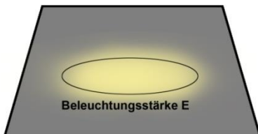
Abb. 77: Beleuchtungsstärke E in Lux (lx) als Quotient des Lichtstroms, der auf eine bestimmte Fläche trifft zur Größe der Fläche.
