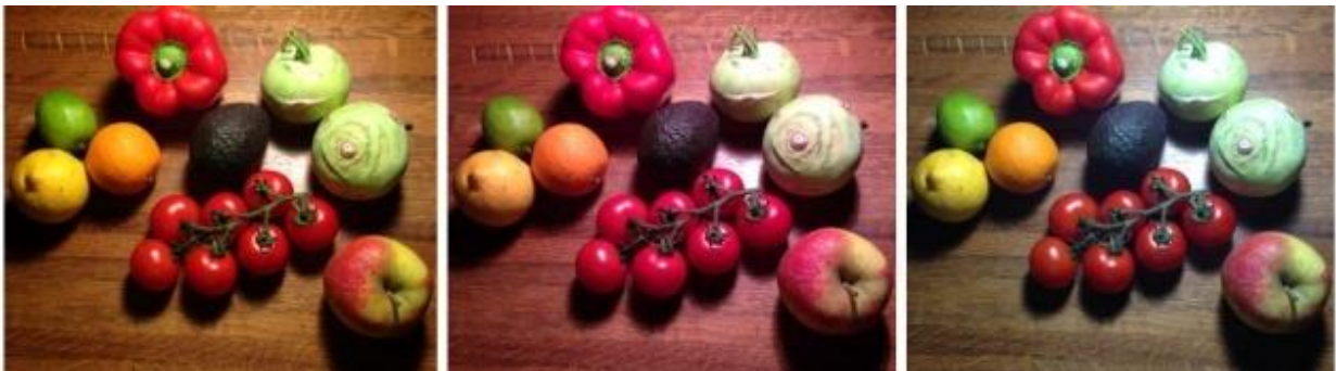
Abb. 79: Je nach Farbtemperatur des Lichtes werden die Farben sehr unterschiedlich wiedergegeben. Bei kühler Farbtemperatur, also kurzwelligem, bläulichem Licht erscheint z.B. der Holztisch grünlich. Links: Halogen Glühlampe, Mitte: 2700K LED, Rechts: 5000K LED.
