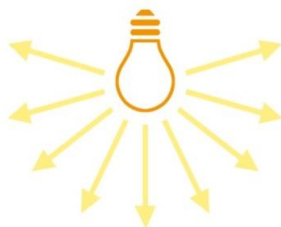
Abb. 75: Lichtstrom \Phi in Lumen (lm) als Maß für die Lichtleistung einer Lichtquelle.
