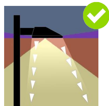
Abb. 24: Seitliches bzw. nach oben abstrahlendes Licht oberhalb des Nutzlicht Strahlungsbereichs ist zu vermeiden und kann nur bei horizontaler, flacher Glasabdeckung und entsprechender Ausrichtung erreicht werden.
